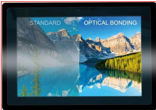
Optical Bonding ist das Bindeglied zweier meist lichtdurchlässiger Materialien mittels extrem klarer Klebstoffe. Die optimale Abstimmung von Verarbeitungsprozess und Material gewährleistet ein luftblasenfreies Verkleben. Durch die Vermeidung eines Luftspalts zwischen den Fügepartnern werden eine wesentlich reduzierte Lichtbrechung sowie verbesserte Kontrastwerte erreicht.
