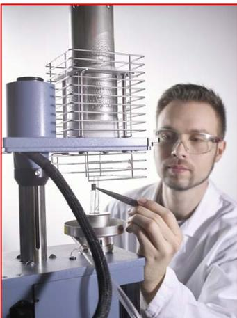
Thermoschock – schockartige Temperaturänderungen im Zusammenhang mit den thermischen Ausdehnungskoeffizienten von Materialien – kann bei empfindlichen und komplexen elektrischen / elektronischen Komponenten wie elektronischen Steuergeräten und Sensoren zu Brüchen der Kontakte und Kabel sowie Rissen im Harz und Spaltrissen zwischen Harz und Kunststoffteil führen.
