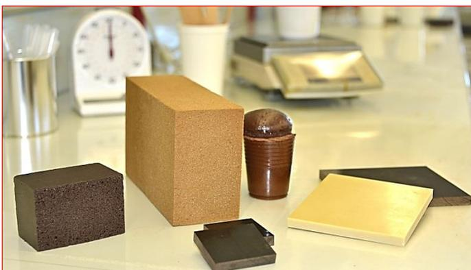
Zug-, Druck- und Biegefestigkeit sind mehr als konkurrenzfähig: ligninbasierte Polyurethan-Weichschäume, Polyurethan-Hartschäume und Polyurethan-Gießmassen (inklusive Referenzmaterial) entwickelt und hergestellt von RAMPF.
