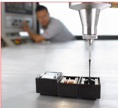
Elektrogießharze von RAMPF Polymer Solutions für elektrische und elektronische Bauteile werden weltweit unter anderem in der Automotive-, Energie-, Automatisierungs- und Haushaltsindustrie eingesetzt.
