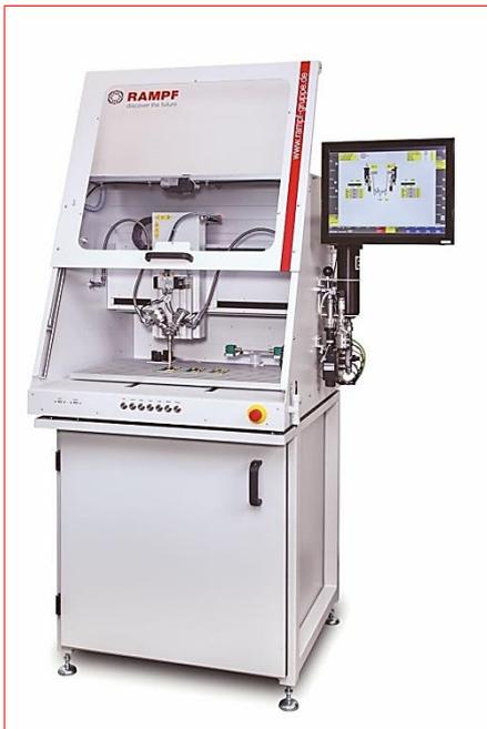
Mit der Tischdosierzelle DC-CNC250 präsentiert RAMPF Production Systems die wirtschaftliche Lösung zur hochpräzisen Dosierung pastöser und abrasiver Materialien. Das Tischgerät mit integriertem Dosiersystem kann frei programmierbare Punkt- oder Bahndosierungen ausführen. Die Dosierung der Einzelkomponenten erfolgt über ein auf extreme Standzeit ausgelegtes Kolbensystem. Hiermit werden höchste Genauigkeiten und lange Standzeiten zwischen Wartungsintervallen erreicht.
