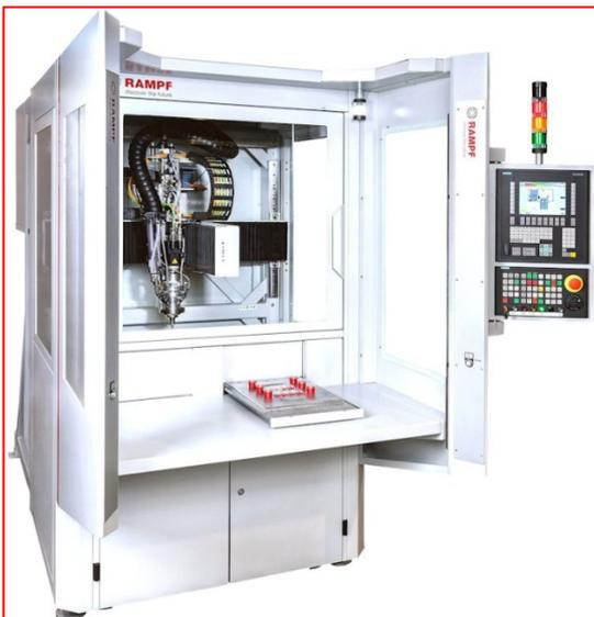
Die Misch- und Dosieranlage DC-CNC800 ist die ideale Lösung für alle Anwender, die einen kompakten Maschinenaufbau benötigen und dennoch keine Kompromisse in der Steuerungstechnik eingehen wollen. Die Anlage verfügt über eine integrierte Materialaufbereitung und kann wahlweise mit Kolben- oder Zahnradpumpen ausgestattet werden.
