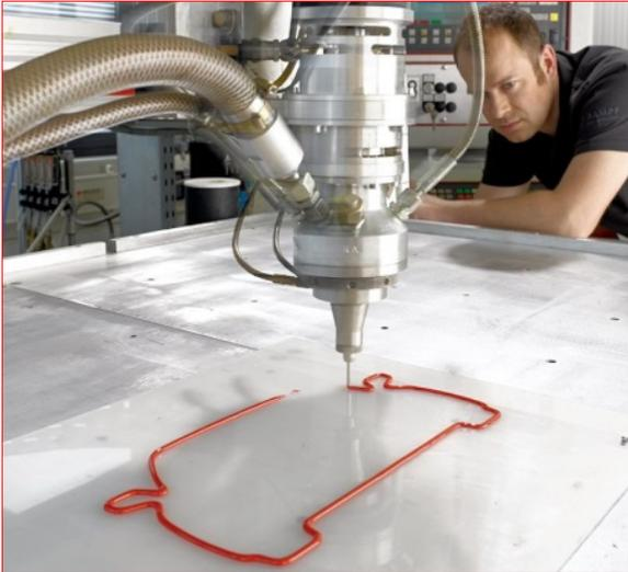
**Dichtungssysteme auf Basis von Polyurethan und Silikon von RAMPF Polymer Solutions** stehen für effizientes Dichten, höchste Qualität und einfachste Handhabung. Geringste Wasseraufnahme, exzellente Haftung, höchste Dauertemperaturbeständigkeit und ein kostengünstiger Verarbeitungsprozess zeichnen sie aus. Kunden weltweit vertrauen auf die flüssigen und thixotropen Dichtungssysteme, unter anderem in der Automotive-, Energie-, Haushalts- und Emballagenindustrie.
