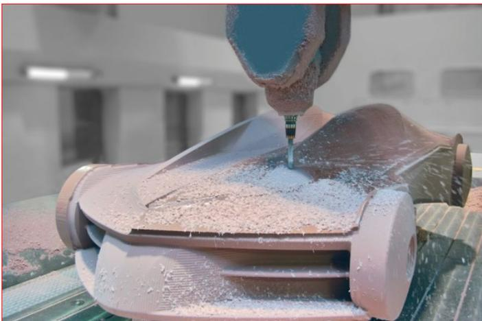
In der Automobilindustrie wird die RAKU-TOOL<sup>®</sup> Close Contour Casting-Technologie auch bei der Herstellung von 1:1-Modellen eingesetzt.
