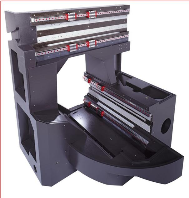
Bett einer Hochgeschwindigkeitsfräsmaschine aus EPUMENT mit hochpräzisen replizierten Oberflächen, montierten Führungen und exakter Verklebung von Bett und Portal
