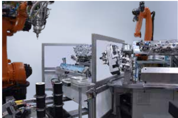
C-DS+RA mit Roboter und Automatisierungseinrichtung zur Integration in einen getakteten Fertigungsablauf
