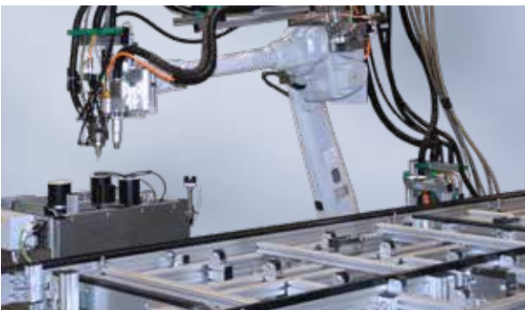
C-DS+RA mit Roboter und Transportband Dosieranwendung integriert in einen Bauteilfluss über Transportbandsystem
