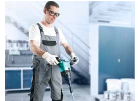
Einfaches Vermischen im mitgelieferten Eimer mit langsam laufendem Rührwerk
