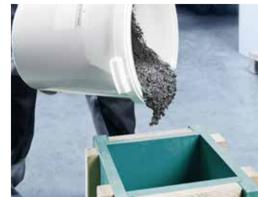
Direktes Verfüllen von Blechbaugruppen oder Verguss in Gießformen bzw. einfache Schalungen
