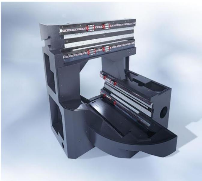
EPUMENT Mineralguss wird zur Konstruktion von Maschinenbetten und Gestellbauteilen wie Ständer, Portale und Traversen verwendet. Mineralguss ermöglicht eine einzigartige Gestaltungsvielfalt und lässt sich genau an die individuellen Kundenanforderungen anpassen.
